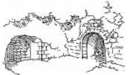
Adaptation de la cave de- moyenne : une façade en tuffeau ferme l'espace habitation. L'entrée de l'annexe est retravaillée en tuffeau appareillé.
