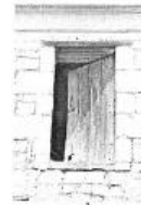
On observe quelques lucarnes en bois ou tuf- feau sur les bâtiments antérieurs au XIX dont le grenier servait de stockage.
